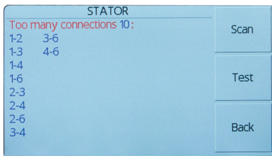
Рисунок 15. Визначення підключення фаз із перевищеним числом фаз, що можуть комутуватися
